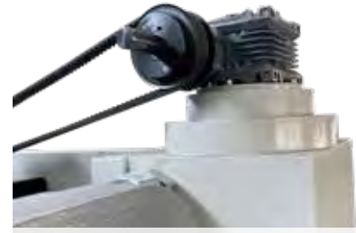
Redüktörlü Motorlu Açı Ayar Sistemi Gear Box Driven Angle Adjustment System
