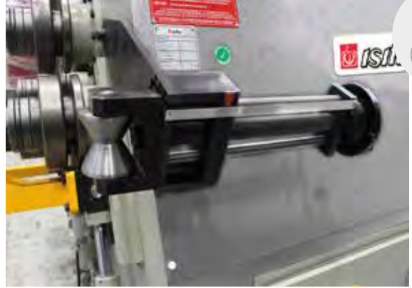
Opsiyonel Mekanik Merdiven Aparatı Optional Mechanical Stairway Bending Attachment
