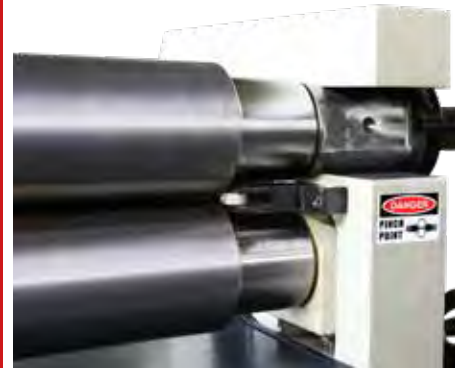
Standart Konik Kıvrırma Makarası Standard Conical Bending Device
