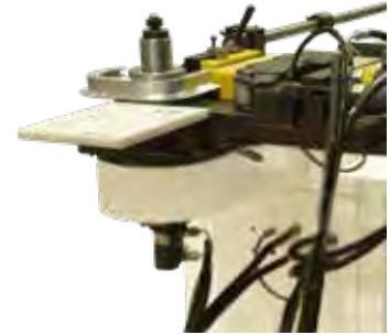
Hidrolik Kalıp Sıkma Hydraulic Tooling Clamp
