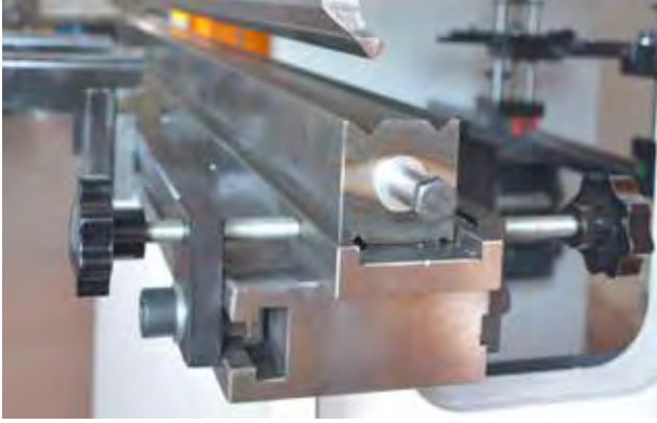
Kolay Ayarlanan Alt Kalıp Tutucu Yatak Easy Lower Bed Adjustment
