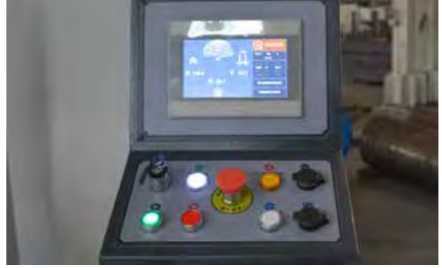
Çoklu Dil Seçenekli Nc Kontrol Ünitesi, 500 Programa Kadar Hafızaya Sahiptir. USB Bellek ile Genişleyebilir. Multilingual NC Controller, 500 Program Memory+ USB Expandable
